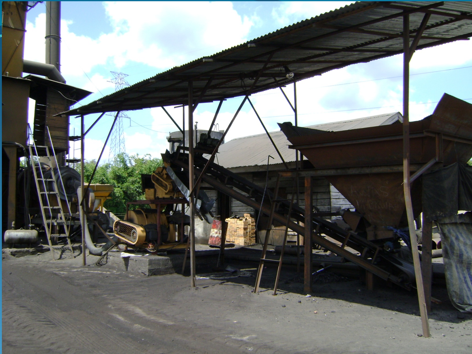
Unit penghancur batubara yang sudah terintegrasi dan diberi atap agar terhindar dari hujan
